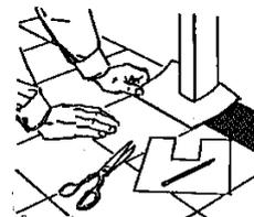
Die Fliesen lassen sich leichter schneiden, wenn sie zuerst über einer heißen Platte oder in einem Ofen für einige Sekunden angewärmt werden.
