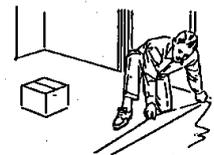
3. Beginnen Sie mit einer Testverlegung ausgehend vom Raummittelpunkt seitlichen hin zu beiden Wänden.
