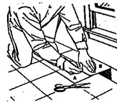
6. Um Fliesen um Hindernisse verlegen zu können, fertigen Sie sich einfach ein Papiermuster an. Übertragen Sie das Muster auf die Fliese und schneiden Sie sie entsprechend zu. Contract S lässt sich leicht schneiden. Zuerst mit einem scharfen Messer eine Kerbe entlang der Linie schneiden und dann an dieser Kerbe auseinanderbrechen.
